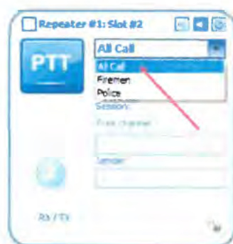
Obr. V programe sú možné volania konkrétnej rádiostanice, skupiny alebo všetkých. Volanie všetkých má veľký význam, lebo v prípade nepredvídaných udalostí dispečer nemusí volať každú skupinu samostatne, ale jedným volaním volá všetky rádiostanice bez rozdielu, v ktorej skupine komunikujú. Volaním všetkých sa urýchlí vyzrozumienie a všetci užívatelia dostanú rovnakú informáciu naraz.
