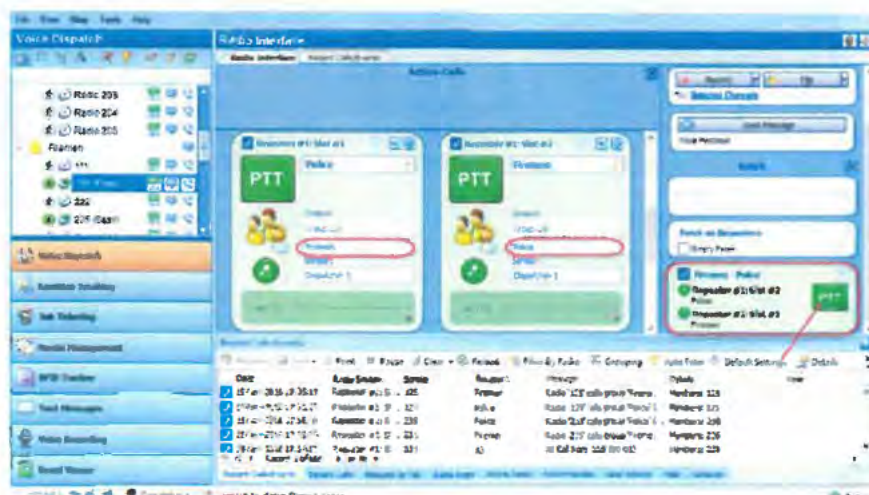
Obr. Volania prepojených skupín v rádiových sieťach. Podobne ako pri volaní všetkých dispečer vie volať len prepojené skupiny, na základe predom vytvorených prepojení, jedným volaním – nie volaním všetkých.
